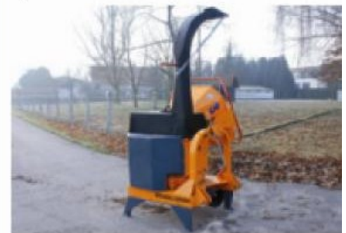
TVI 60 PT ; optionele 270° draaibare uitvoering voor driepuntsversie
