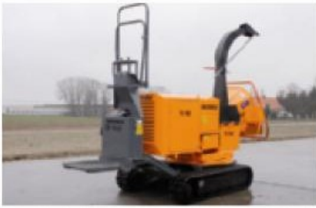
Hydraulisch aangedreven op rupsonderstel
